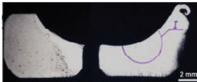
17. Szlify przekrojów poprzecznych próbek półpięścieni wewnętrznych trawione nitałem z zaznaczeniem miejsca obserwacji pod większym powiększeniem [5]
