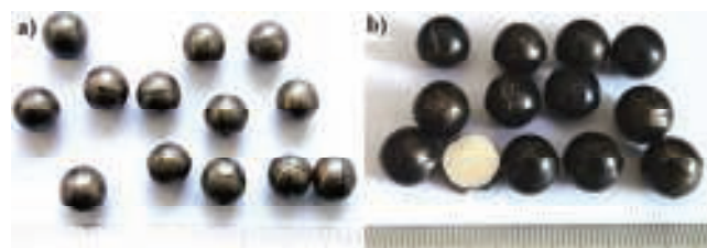
7. a) Kulki łożyska A; b) powierzchnia jednej z kulek łożyska A; c) kulki łożyska (jedna z kulek została przecięta)
