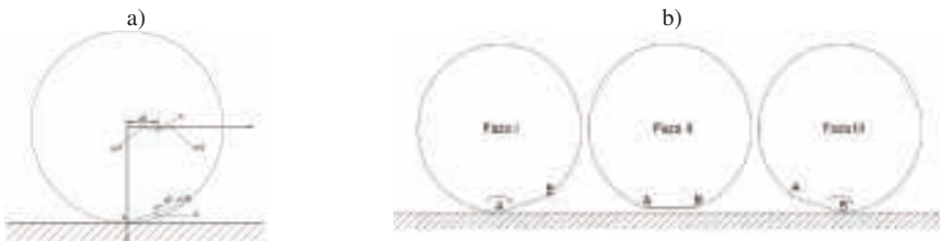
8. Płaskie miejsca na kole [13,19], a) schemat koła z płaskim miejscem; b) ruch koła z płaskim miejscem – przypadek z oderwaniem od szyny
