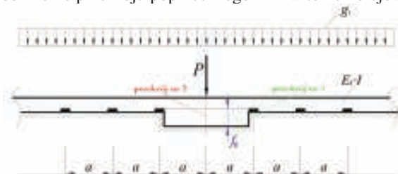
6. Schematy wywołanych nierówności w torze kolejowym [6]
