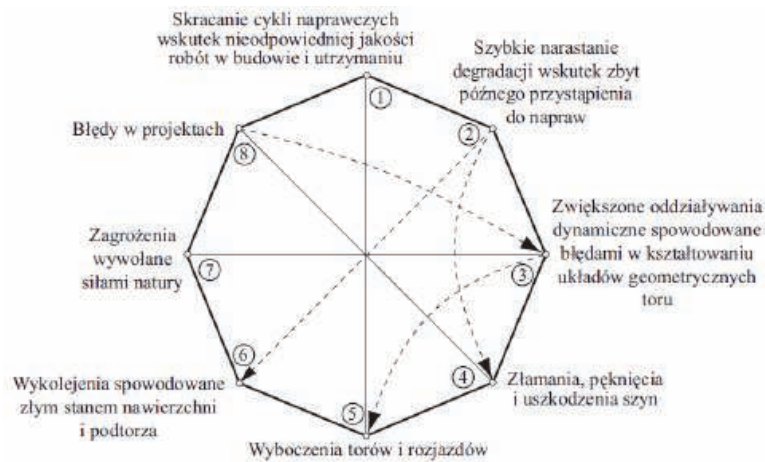
12. Podstawowy podział przyczyn i skutków powstawania imperfekcji w torze kolejowym [2]
