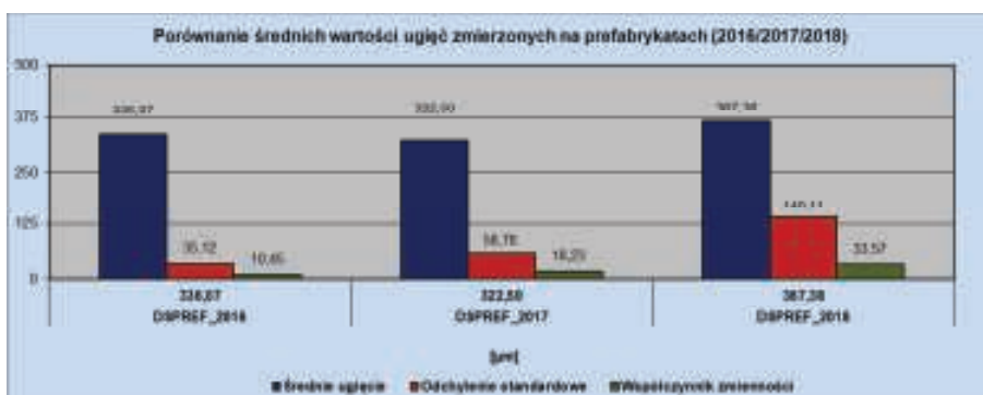
6. Średnie wartości ugięć sprężystych dla prefabrykatów – porównanie badań z lat 2016, 2017, 2018
