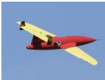
12. Odrzutowy cel powietrzny z programowaną trasą lotu JET-2 (źródło: materiały własne ITWL)
