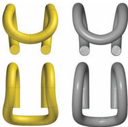
5. Widoki z przodu i z góry – porównanie modelu CAD (z lewej) z siatką rzeczywistej łapki nr 1 (z prawej)
