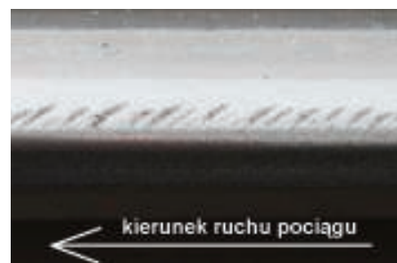
1. Przykład wady typu headcheck
