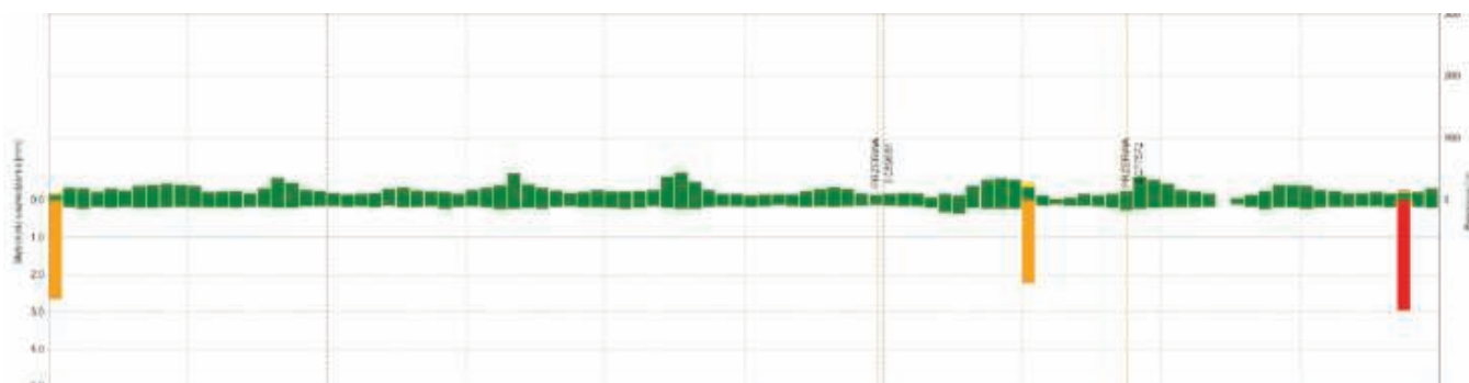
6. Wady typu headcheck na odcinku 3 (R~500 m, 40 Tg)
