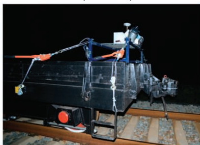
5. Przykładowa architektura pomiarowa GNSS/INS/MLS, wykorzystana w badaniach opisanych w pracy [19]: a) widok urządzenia; b) platforma pomiarowa
