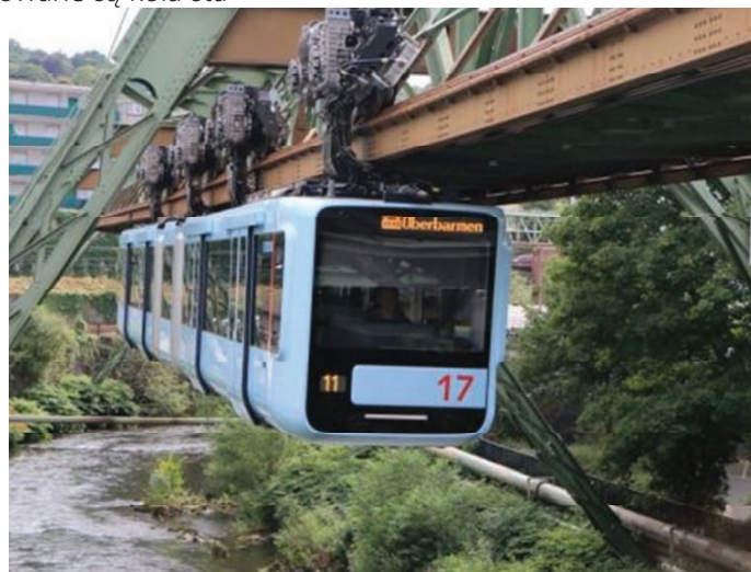
6. Kolej jednoszynowa w Wuppertalu (Niemcy) wykorzystująca system „Double-flanged”. Źródło: strona internetowa [27]
