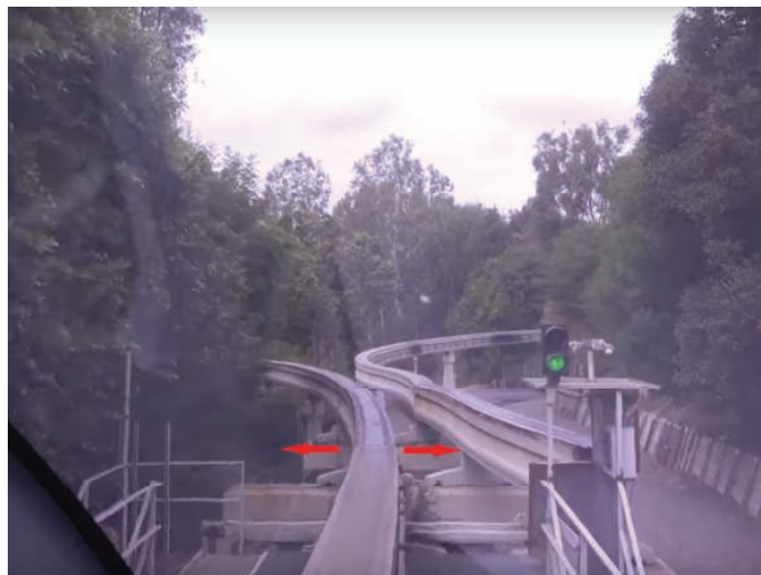
12. Rozjazd wykorzystujący mechanizm przesuwny Źródło: strona internetowa [28]
