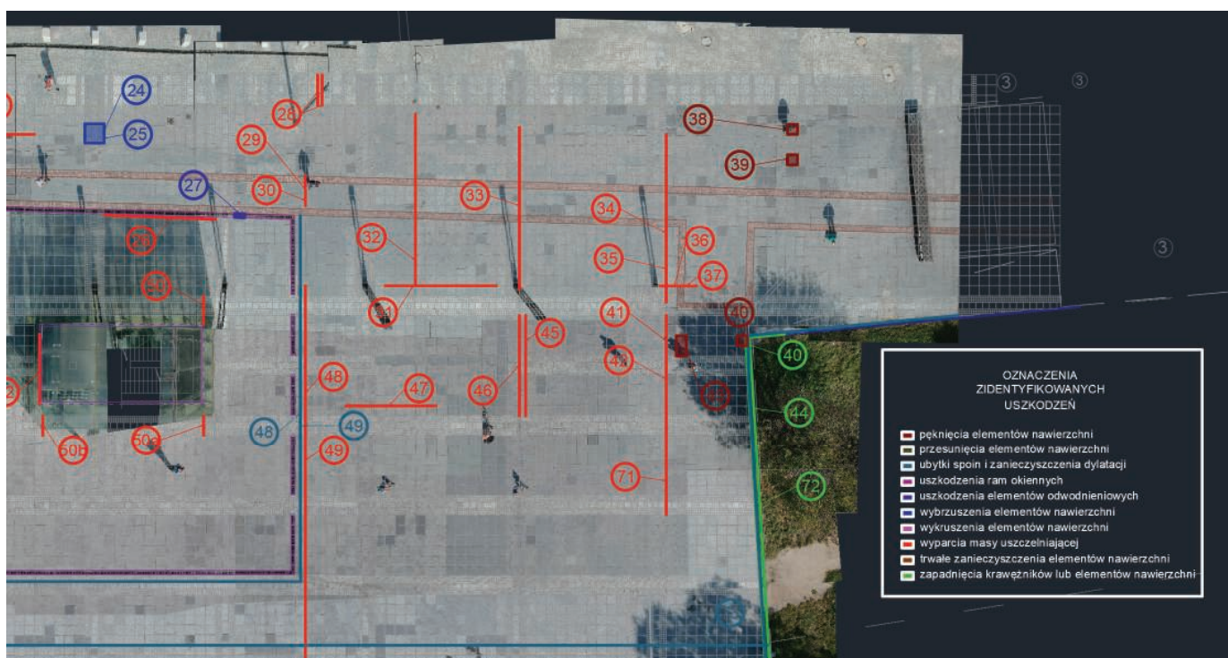
8. Przykładowy rezultat skalibrowanej mapy obiektu z naniesionymi uszkodzeniami
