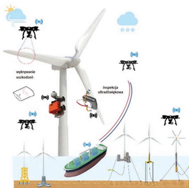
3. Platformy zrobotyzowane w procesie inspekcji morskich farm wiatrowych. Źródło: [8]
