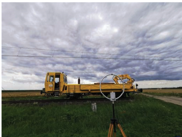
11. Stanowisko do pomiarów emisji zaburzeń promieniowanych w paśmie częstotliwości 150 kHz – 11 MHz
