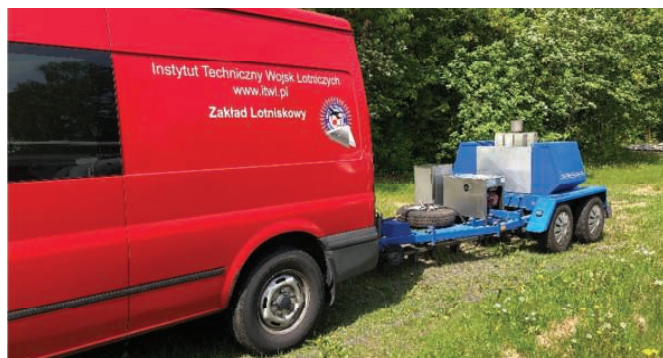
13. Pomiar nośności ugięciomierzem lotniskowym HWD
