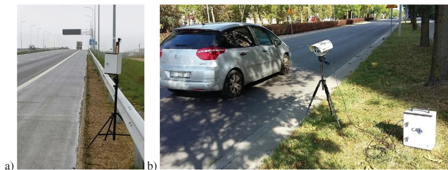
6. Aparatura do pomiaru prędkości pojazdów: a) chwilowej – Sierzeja SR4, b) odcinkowej – kamera ANPR (jedna z dwóch na odcinku)
