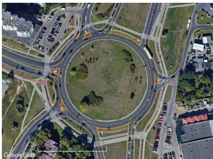
9. Pięciowłotowe Rondo Uniwersyteckie o średnicy zewnętrznej równej 125 m (Źródło: wizualizacja oznakowania poziomego wykonana przez autorów na tle zdjęcia satelitarnego z programu [18] – współrzędne geograficzne 53°24'12.18"N, 14°30'5.00"E)
