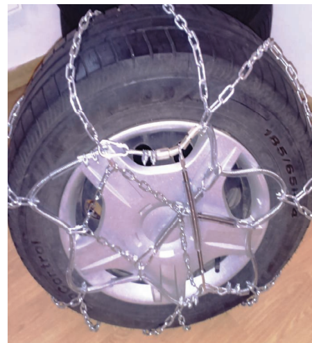
4g. Przykład nietypowego, „awaryjnego” zastosowania elementów napinacza na kole o zbyt małych rozmiarach; tu: zamiast koła z oponą 195/65/15 jest 185/65/14 – jeden z elementów świadczących o uniwersalności opisywanego projektu. Z kolei przy kole o większych rozmiarach wielkość zestawu dopasowujemy dodając lub odejmując odpowiednio liczbę łączników wewnętrznych i zewnętrznych
