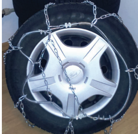
4f. Przygotowanie do nietypowego, „awaryjnego” przyczepienia elementów napinacza, gdyż przykładowe koło jest znacznie mniejszych rozmiarów od rozmiarów testowanego wcześniej koła
