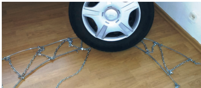
4b. Przełożenie całości za oponę, tak, aby część środkowa, podzielona na dwa segmenty, znajdowała się za kołem
