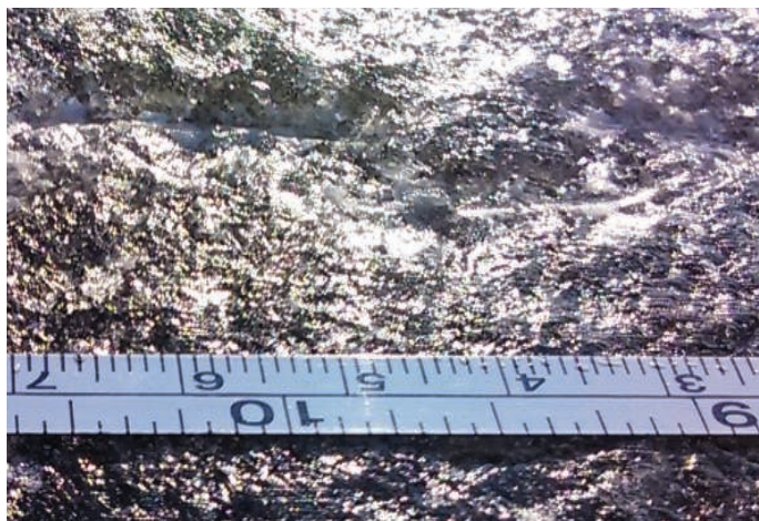
1. Wykruszony lód pod naciskających ogniw stalowego łańcucha – powstałe zagłębienia w wyniku przekroczenia doraźnej wytrzymałości lodu na ściskanie; test wykonany przy temperaturze otoczenia -13°C
