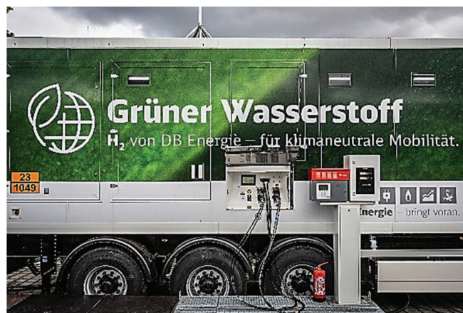
3. Przykład mobilnej stacji tankowania wodoru przeznaczonej dla sektora kolejowego. Źródło [7]
