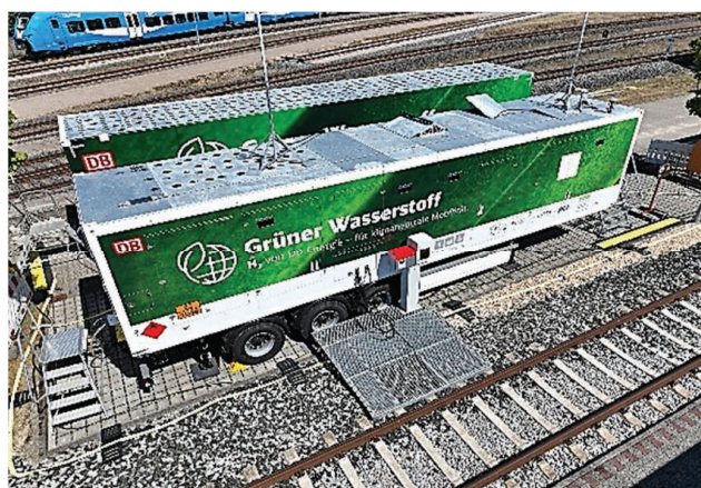
3. Przykład mobilnej stacji tankowania wodoru przeznaczonej dla sektora kolejowego. Źródło [7]
