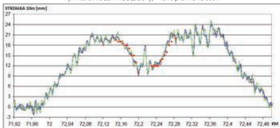
5. Porównanie wyników pomiarów wykonanych strzałkomierzem (czerwony) z pomiarami wykonanymi toromierzem iTEC (zielony) na przejeździe kolejowym w okolicach 72,2 [km]
