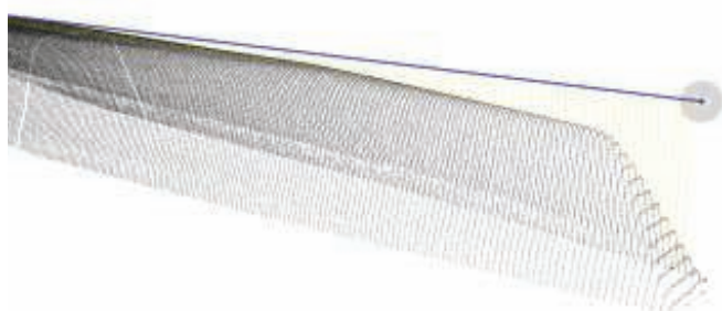
11. Przykład oceny profilu wzdłużnego dzioba krzyżownicy (z lewej model 3D krzyżownicy z zaznaczonym kierunkiem oceny, z prawej profil dzioba krzyżownicy wzdłuż zdefiniowanego kierunku oceny)
