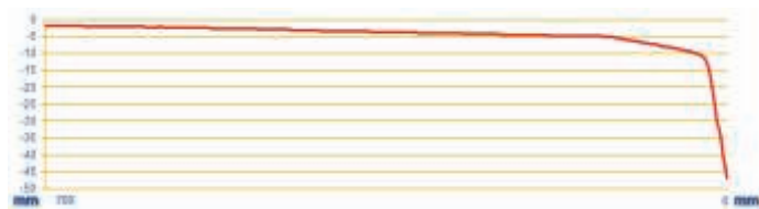
11. Przykład oceny profilu wzdłużnego dzioba krzyżownicy (z lewej model 3D krzyżownicy z zaznaczonym kierunkiem oceny, z prawej profil dzioba krzyżownicy wzdłuż zdefiniowanego kierunku oceny)
