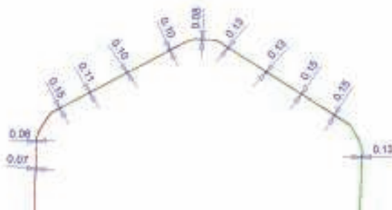
4. Wyniki porównania zmierzonego profilu z certyfikowanym wzorcem pomiarowym. Powtarzalność zmierzonego profilu < 0.10mm, odtwarzalności dla 10 pomiarów < 0.15mm
