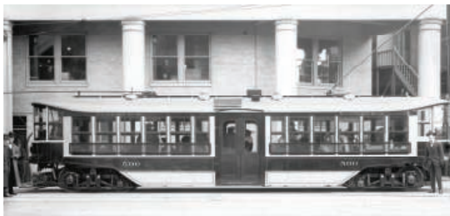
3. Tramwaj niskopodłogowy firmy Brill, Vancouver, ok. 1910 [8]
