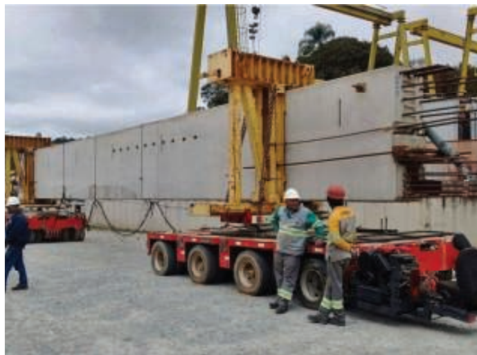
7. Naczepa transportująca dźwigar [12]
