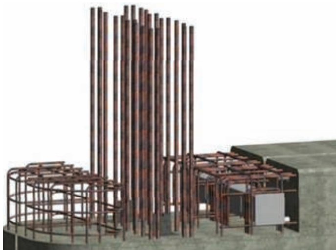
6. Wizualizacja przerwy roboczej w oczeple filara układu zespolonego [2]
