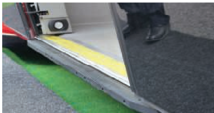
6. Drzwi tramwaju Skoda Forcity Plus wyposażone w próg
