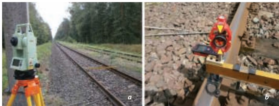
2. Pomiar geometrycznych warunków widoczności przejazdu kolejowo-drogowego: a) tachymetr TC407 Leica, b) adapter zamontowany z minipryzmatem GMP111 i z dalmierzem laserowym na toromierzu manualnym
