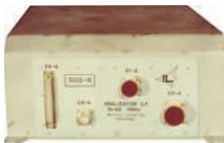
2. Aparatura „SAWA BUD A” do analizy widma fal plazmowych w zakresie 2-105 Hz [2]
