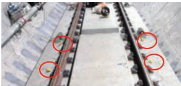
11. Lokalizacja czujników pomiarowych na płycie betonowej z systemem wibroizolacji sprężynowej na linii metra nr 10 w Szanghaju
