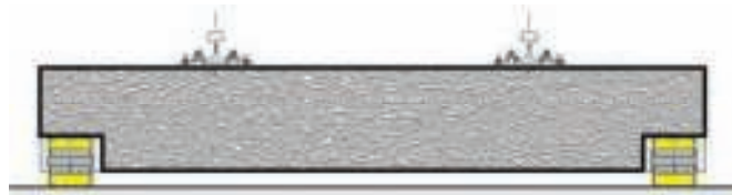
4. Wibroizolatory KY w bezpodsytkowej nawierzchni szynowej (GERB)
