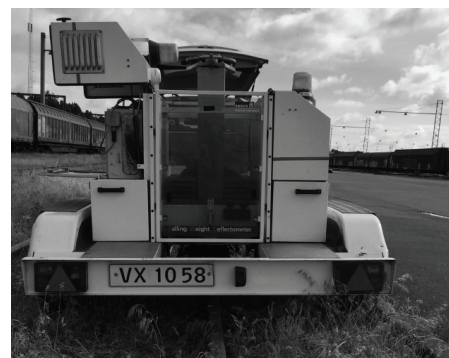
8. Urządzenie pomiarowe FWD podczas pomiarów
