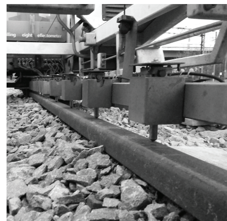
9. Rozmieszczenie czujników (geofonów) do pomiaru ugięć
