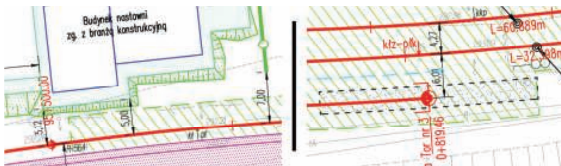
3. Fragmenty omawianego w tekście rysunku planu, kreskowaniem w kolorze zielonym zaznaczono zasięg układania maty wibroizolacyjnej
