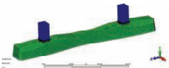
4. Model 3D podkładu PS-94 w Autodesk Simulation Multiphysics
