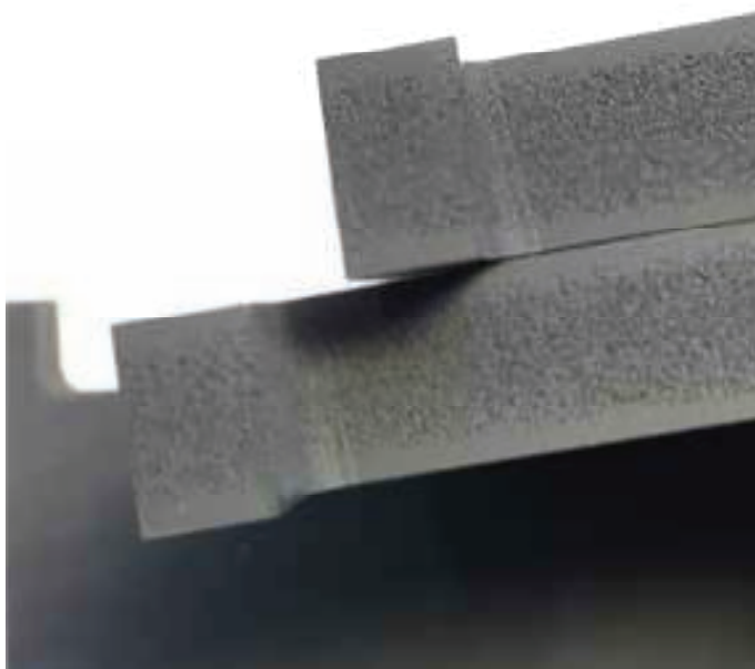
4. Widok boczny przekładki podszykowej ze spienionego EPDM, za [5]
