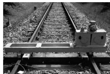
5. Wzbudnik bezwładnościowy rotacyjny wraz z siłownikami pałkowymi [7]
