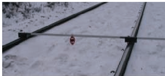
5. Przrząd do identyfikacji i pomiaru osi toru
