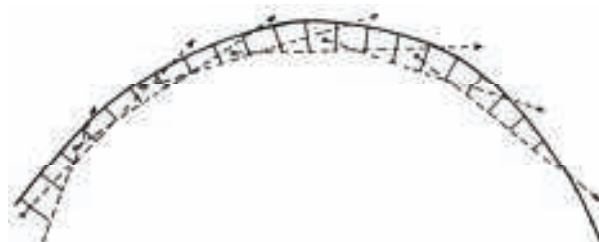
3. Pośredni pomiar strzałek
