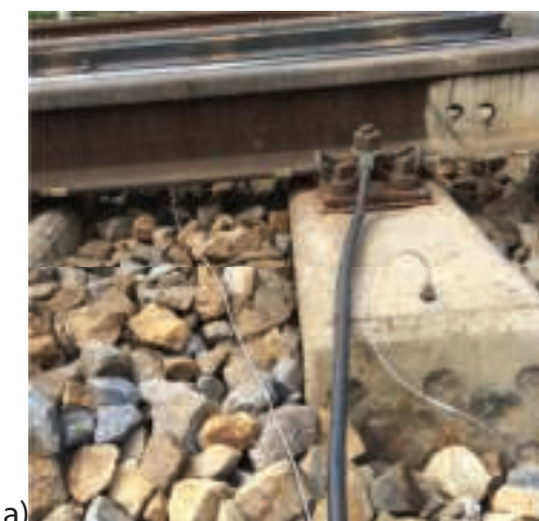
9. Aparatura pomiarowa i lokalizacja czujników pomiarowych w rozjeździe, a- czujniki na szynie i podrozjazdnicy, b- czujniki w podtorzu
