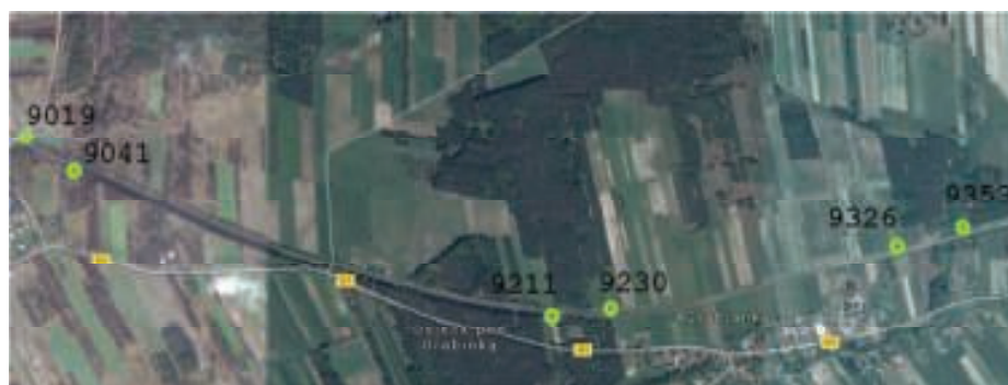
9. Rozmieszczenie punktów osnowy podstawowej
