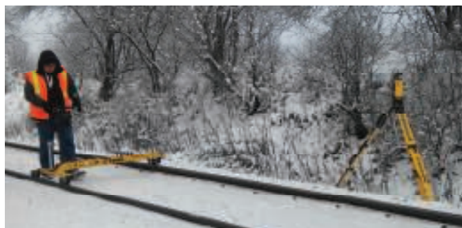
6. Pomiar torów metodą jednowózkową
