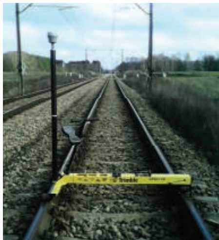
8. Zestaw GEDO do pomiaru torów metodą GNSS
