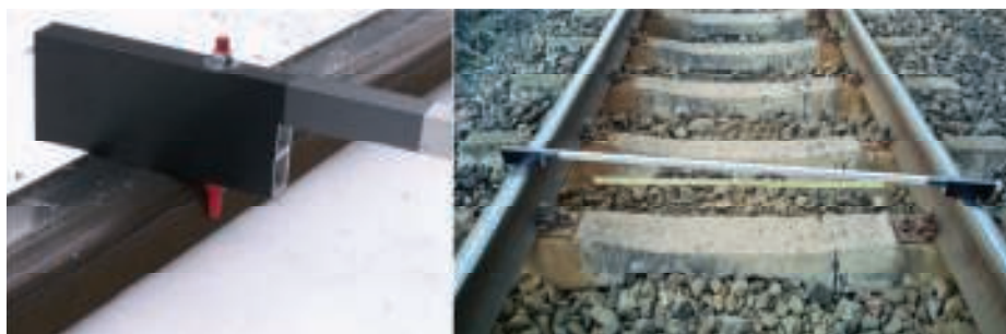
10. Przyrząd pomocniczy do ustalania osi toru
