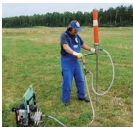
9. Sondowanie sondą DPL
