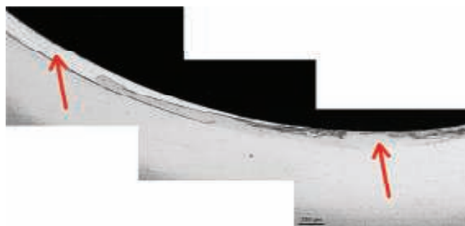
12. Mikrostruktura środkowej części bieżni zewnętrznej łożyska B, ze wskazaniem miejsca pomiaru twardości warstwy
