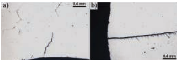
18. a) Mikrostruktura szlify przekroju w obszarze zaznaczonym na rys. 17; b) Mikrostruktura szlify przekroju kulki [5]
