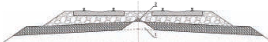
2. Kształt warstwy ochronnej podtorza uzyskany po przebudowie realizowanej w trybie zamknięcia jednotorowych. 1 – Obszar braku warstwy ochronnej. 2 – Obszar nienaruszonej istniejącej podsypki
