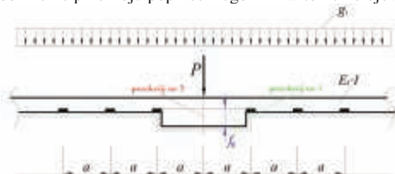
6. Schematy wywołanych nierówności w torze kolejowym [6]
