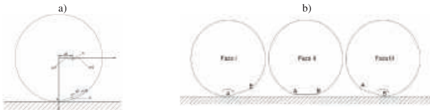
8. Płaskie miejsce na kole [13,19], a) schemat koła z płaskim miejscem; b) ruch koła z płaskim miejscem – przypadek z oderwaniem od szyny
