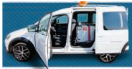
3. Widok urządzenia wybudowanego na potrzeby oznaczania wartości współczynnika przyczepności nawierzchni lotniskowych
