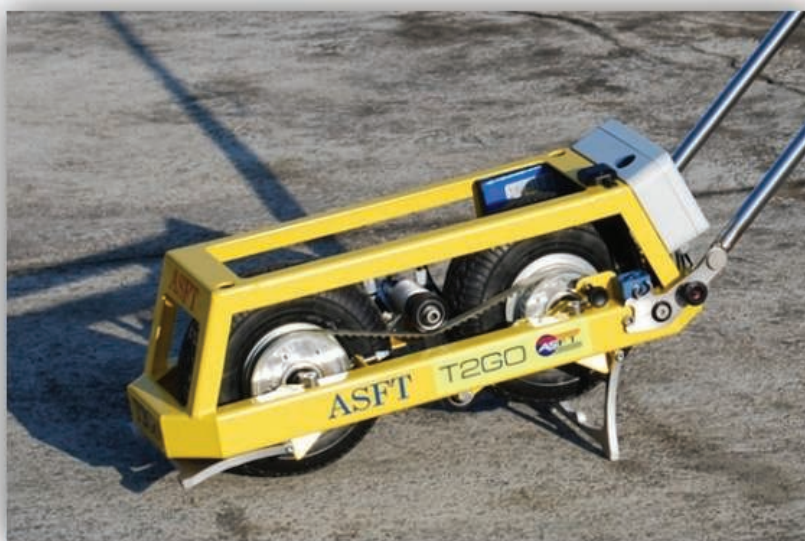
2. Pomiar współczynnika tarcia na nawierzchni płyty postoju samolotów przy użyciu urządzenia T2Go będącego na wyposażeniu Zakładu Lotniskowego ITWL
