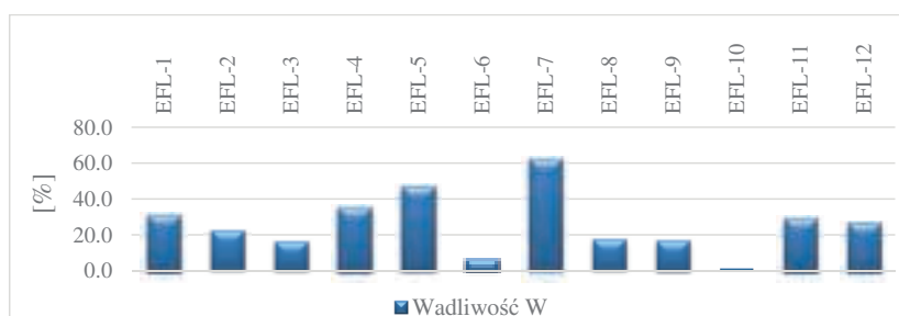
8. Procentowa ilość płyt przekraczające wymagania normowe (wadliwość) na poszczególnych EFL
