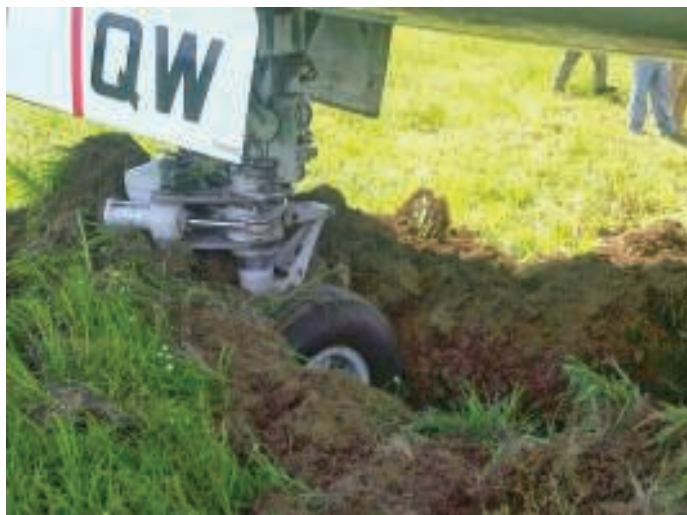
1. Prezentacja skutków niedostatecznej nośności naturalnej nawierzchni lotniskowej [8]
