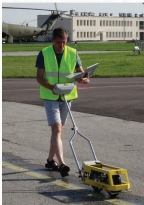
2. Pomiar współczynnika tarcia na nawierzchni płyty postoju samolotów przy użyciu urządzenia T2Go będącego na wyposażeniu Zakładu Lotniskowego ITWL
