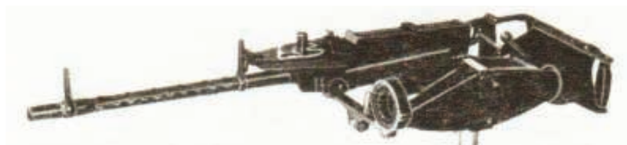
4. Fotokarabin maszynowy K-28 sprzężony z km obserwatora [6]
