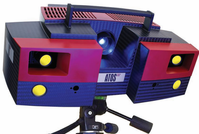
1. Głowica skanera 3D GOM Atos Triple III (a), łapka SB4 podczas skanowania (b)
