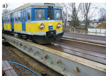
3. Przęsło odcciążające KO30: (a) konstrukcja wbudowana w torze 502 PKP SKM podczas badań eksploatacyjnych, (b) wizualizacja modelu numerycznego przęsła (SOFISTIK)
