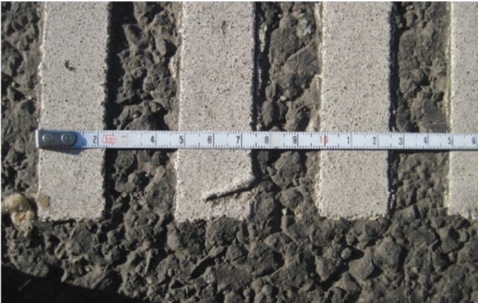
17. Parametry odległościowe elementów fragmentu pasa prowadzącego (nowego) - pomiar własny, Rondo Księstwa Cieszyńskiego, Cieszyn / Polska (fot. A. Piętka)
