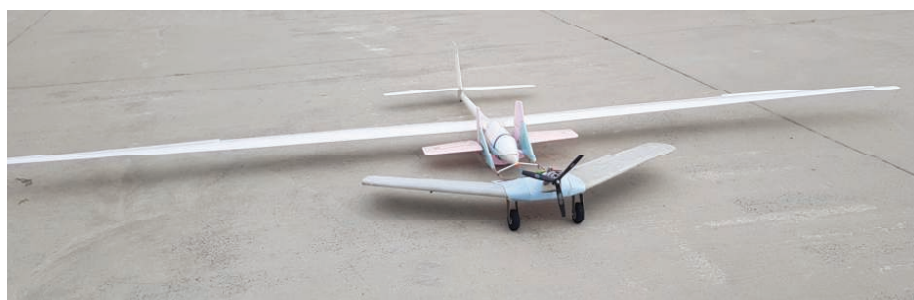
8. Model zespołu szybowiec i BSP-holownika - wersja 2 z obniżoną wieżyczką silnika i podwoziem z tylnym punktem podparcia. Źródło: archiwum T. Muszyński
