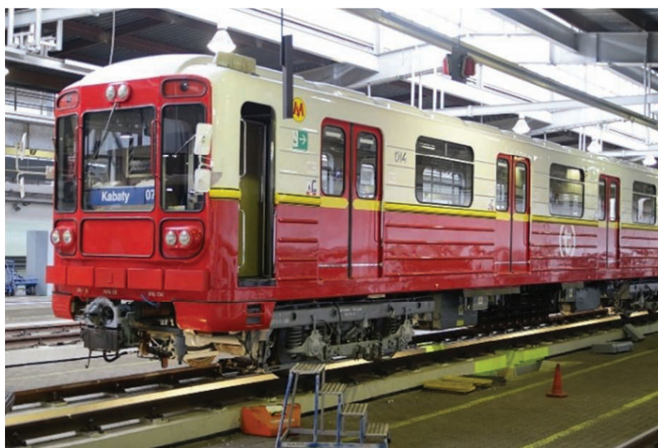
1. Pojazd serii 81 typu 81572P i 81-573P. Pojazdy z jednostkami napędowymi prądu stałego (24 x 110 kW) na każdą oś. Pudło wagonu jest spawaną konstrukcją stalową. Masa pojazdu 200 ton.
