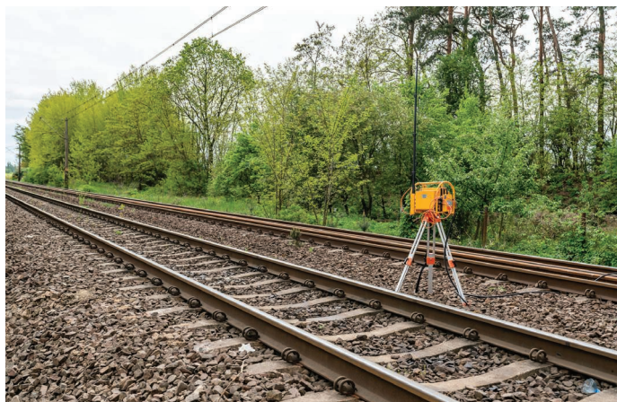
3. Nadajnik radiowy połączony z indukcyjnym detektorem kół pojazdu szynowego
