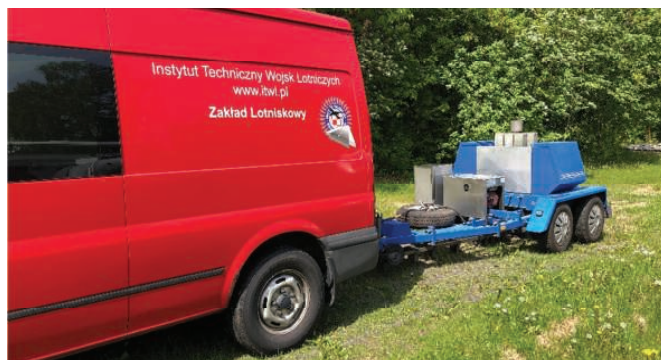
13. Pomiar nośności ugięciomierzem lotniskowym HWD
