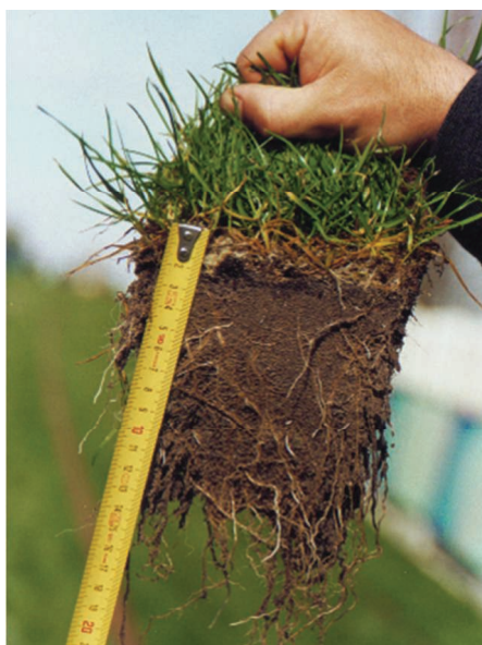
6. Ukorzeniona warstwa z zastosowaniem włókien polimerowych
