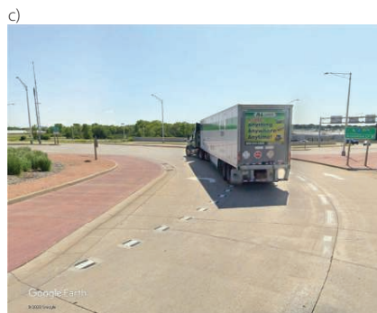
3. Rondo typu „look-a-like” na skrzyżowaniu drogi stanowej 41 z ulicami Breezewood Ln oraz W Bell St Neenah w USA: a) plan czterech rond; b) mulda i dostosowane wpusty deszczowe do jej obłego kształtu; c) widok na krawężnik oddzielający przejezdny część rondo od jezdni rondo (Źródło: Google Earth [18] – współrzędne geograficzne 44°9'22.55"N, 88°29'8.49"W)
