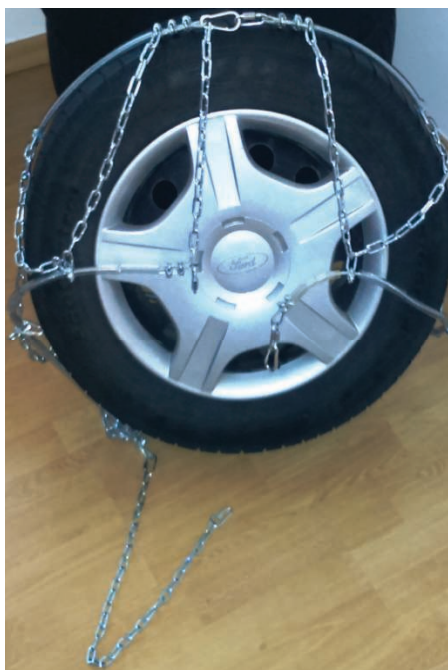
4c. Połączenie końców cięgna wewnętrznego wykonane u góry na oponie – cięgno zewnętrzne jest jeszcze rozłączone
