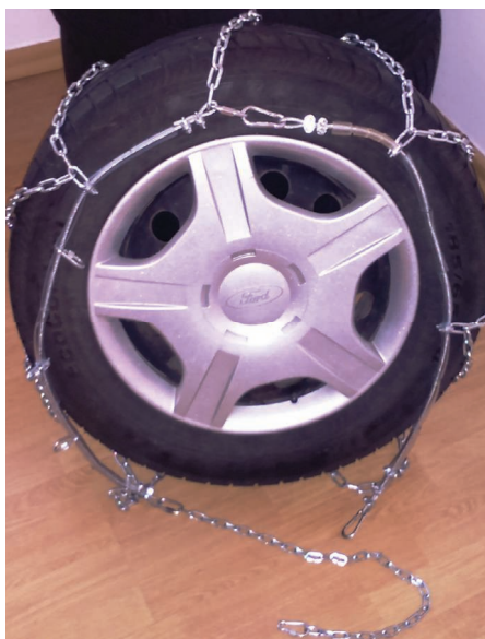
4e. Równomierne, symetryczne ułożenie elementów na bieżniku opony, a następnie połączenie końców cięgna zewnętrznego u dołu koła. Przełożenie cięgna napinacza kolejno przez odpowiednie łączniki boczne, które są zainstalowane na cięgnie zewnętrznym
