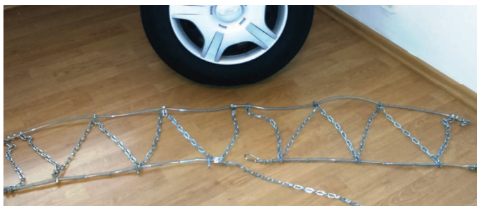
4a. Sposób montażu na koło: ułożenie przed kołem całości zestawu i sprawdzenie kompletności elementów – tu: dla przejrzystości widoku odczepiono część z urządzeniem napinającym
