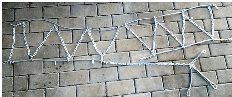
3. Jeden z prototypów, które spełniają większość założeń przyjętych w projekcie urządzenia antypoślizgowego, [12]
