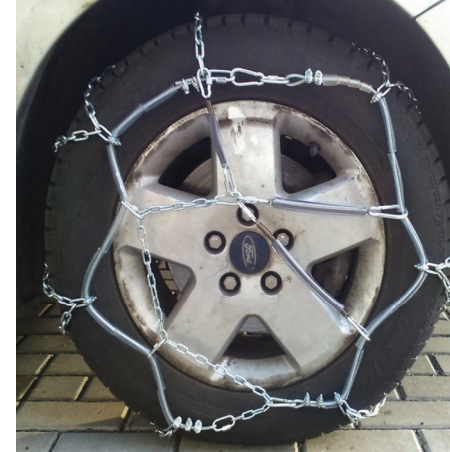
4h. Widok urządzenia antypoślizgowego na kole z oponą o rozmiarze 195/65/15 z przykładowym napinaczem trójelementowym
