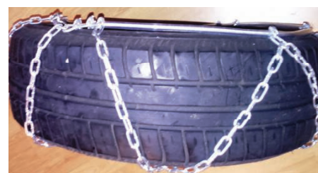
7. Widok łączników i testowanej geometrii śladu urządzenia antypoślizgowego na oponie, także przy zdjętym kole
